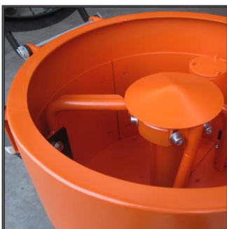
Lem nádoby zabraňující úniku materiálu
